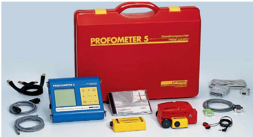
شكل 2-18 يوضح جهاز قياس أسياخ الحديد مع التوصيلات التابعة له
