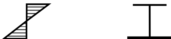
ب- إضافة اللوح بعد إزالة الحمل الميت شكل (٣-٢) تأثير الحمل الميت على توزيع الإجهادات في الجسر الأصلي والجزء المضاف
