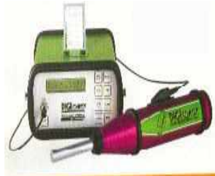
شكل ٢-١٢ أ- مطارق خاصة بقياس مقاومة الخرسانة
