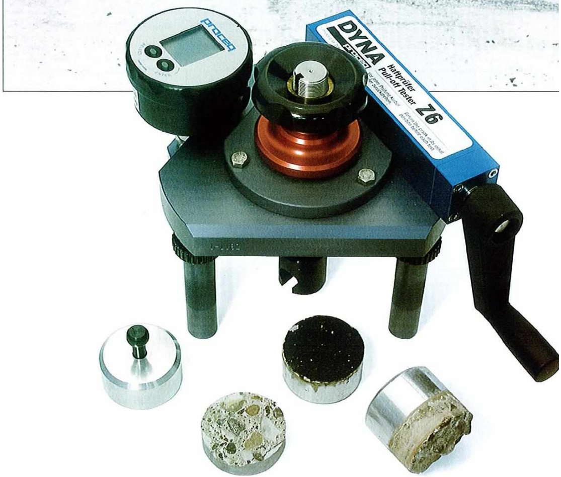
شكل رقم ٢٦-٢ يوضح جهاز اختبار السحب مع عينات تم سحبها من الخرسانة
