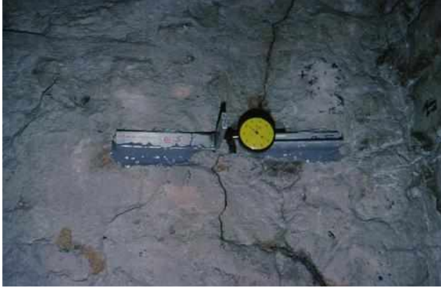
شكل ٢-٨ يوضح طريقة قياس التشقق
