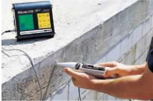
شكل ٢-١١ مطرقة خاصة بقياس مقاومة الأسفلت
