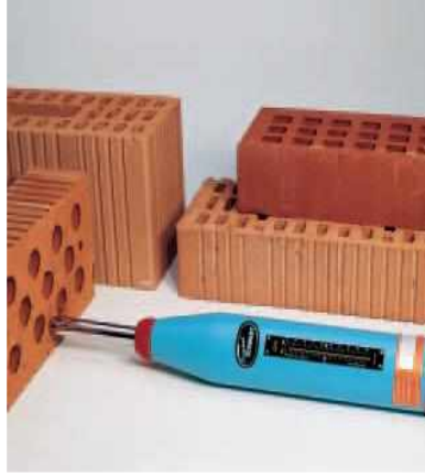
شكل ٢-٩ مطرقة خاصة بقياس مقاومة الطوب
