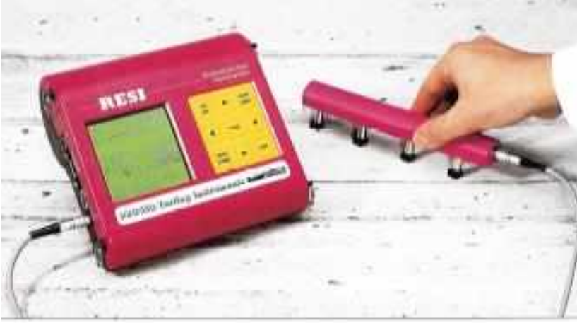
شكل ٢-16 يوضح جهاز قياس المقاومة الكهربائية
