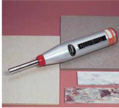
شكل ٢-١٠ مطرقة خاصة بقياس مقاومة البلاط
