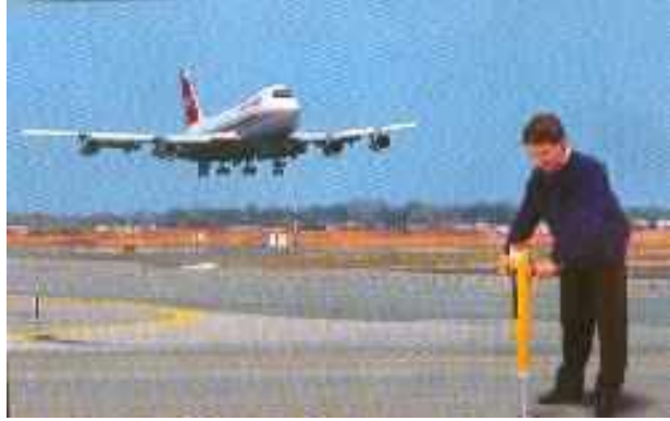
شكل ٢-١١ مطرقة خاصة بقياس مقاومة الأسفلت
