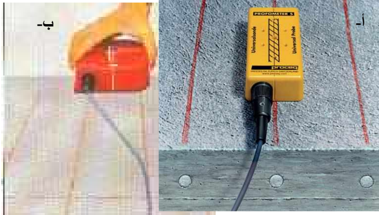
شكل 2-17 يوضح طريقة معرفة مواقع وأقطار الأسياخ
